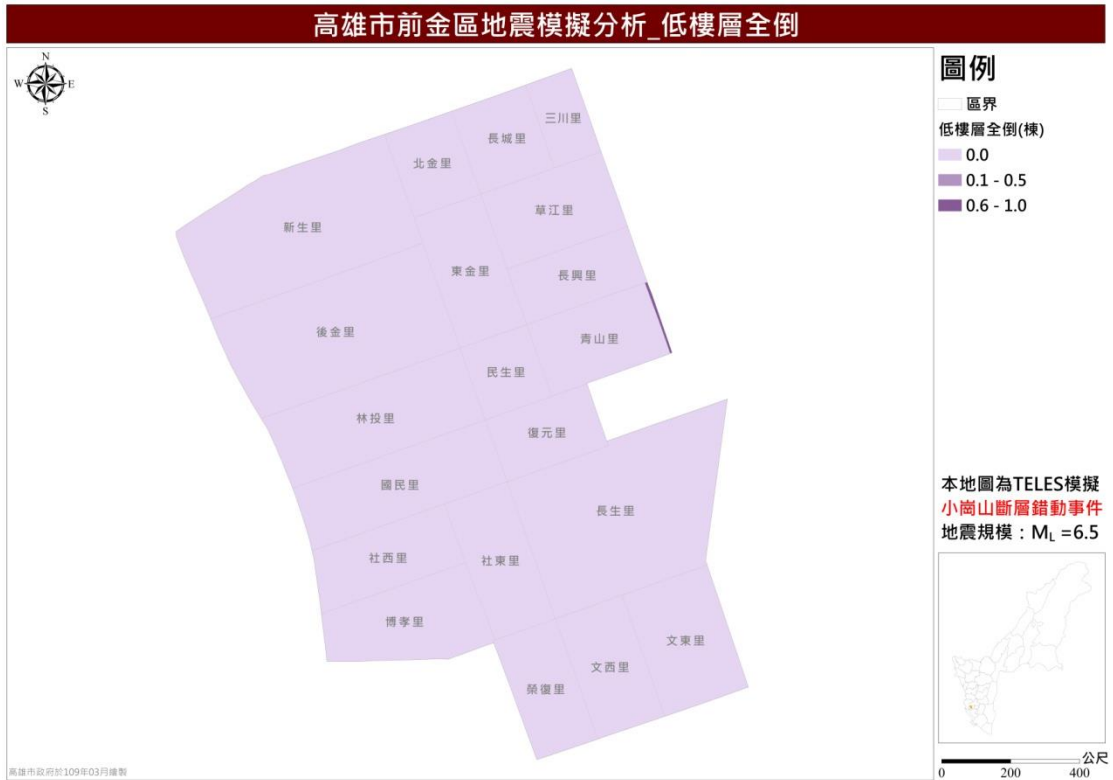
圖 17 小崗山斷層錯動事件低樓層全倒棟數推估圖
