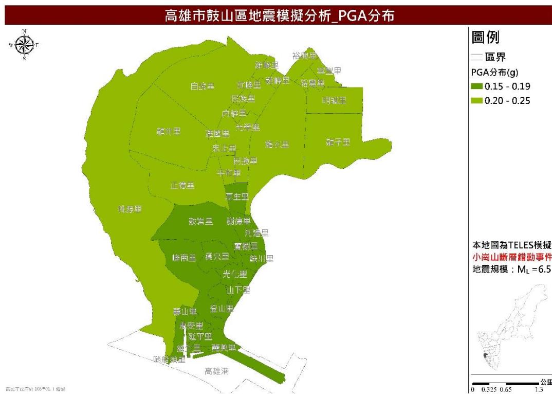
圖 35 鼓山區小崗山斷層錯動事件最大地表加速度(PGA)分佈圖
