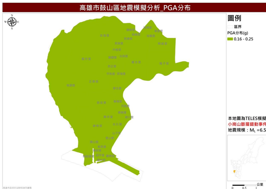
圖 14 小崗山斷層錯動事件最大地表加速度（PGA）分布圖
