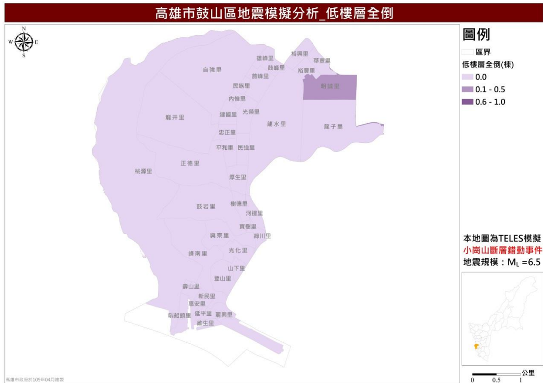
圖 18 小崗山斷層錯動事件低樓層全倒棟數推估圖
