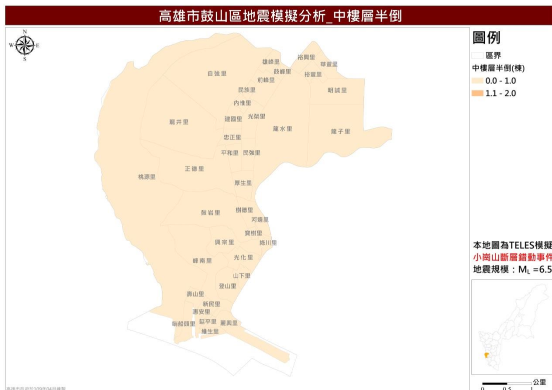
圖 22 小崗山斷層錯動事件中樓層半倒棟數推估圖
