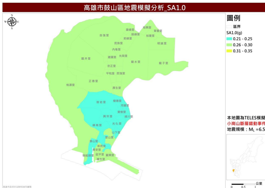
圖 16 小崗山斷層錯動事件長周期譜加速度（SA1.0）分布圖
