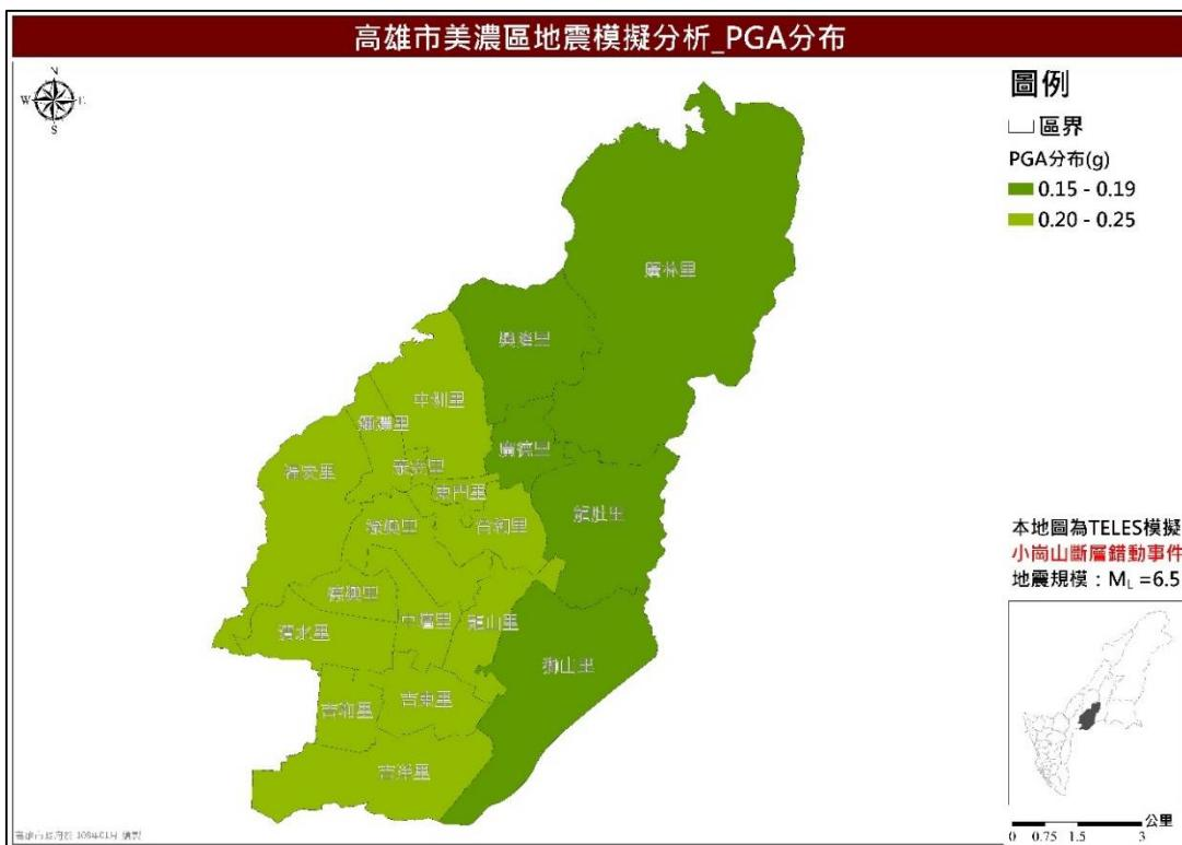
圖 13 小崙山斷層錯動事件最大地表加速度 (PGA) 分布圖
