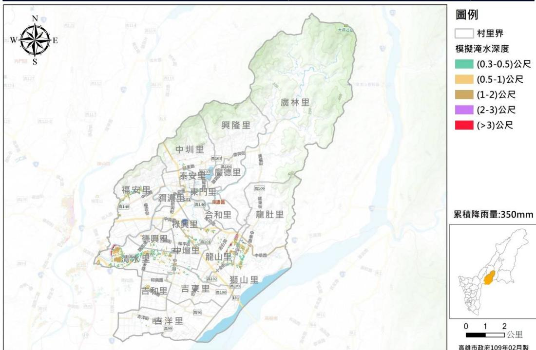
圖 7 美濃區淹水災害潛勢圖 (模擬 24 小時累積降雨量 350mm)
