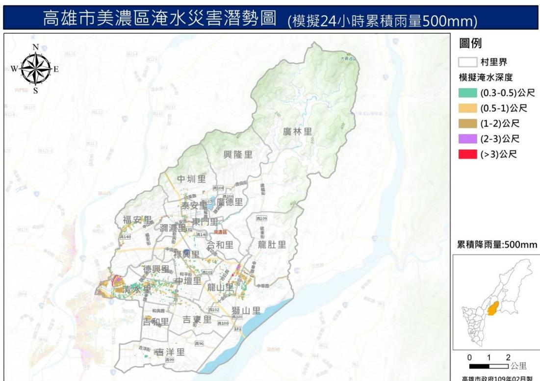
圖 6 美濃區淹水災害潛勢圖 (模擬 24 小時累積降雨量 500mm)
