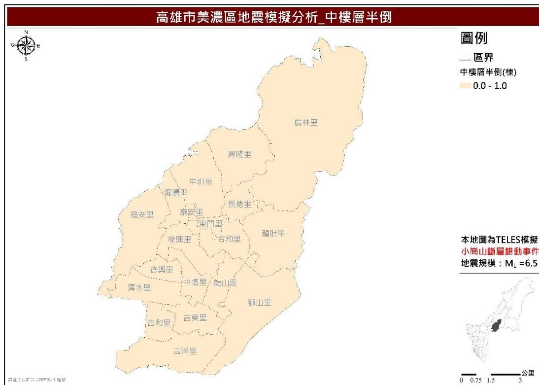
圖 21 小崙山斷層錯動事件中樓層半倒棟數推估圖
