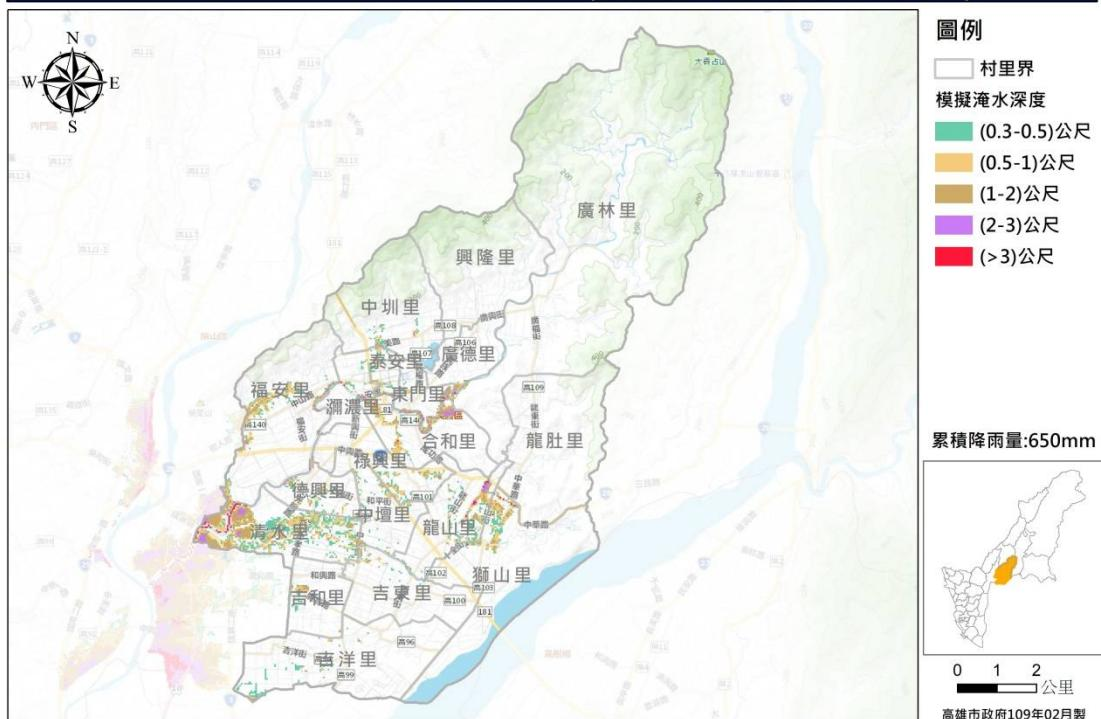
圖 5 美濃區淹水災害潛勢圖 (模擬 24 小時累積降雨量 650mm)
