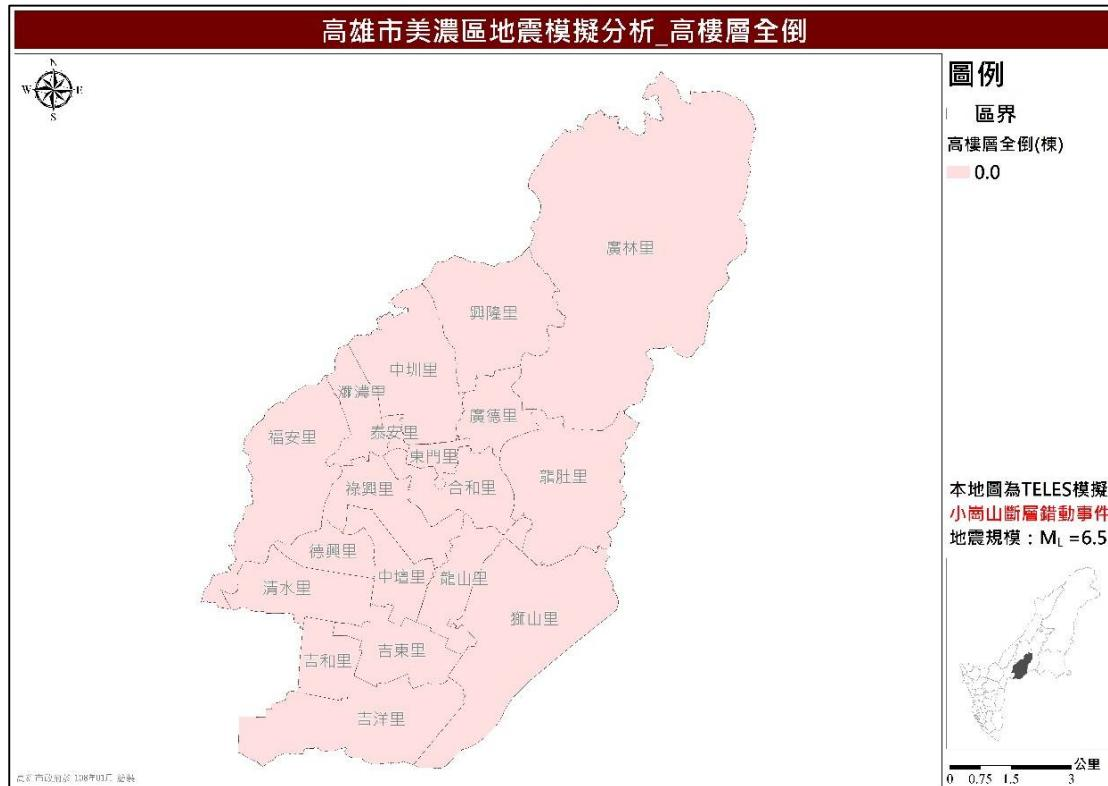
圖 19 小崙山斷層錯動事件高樓層全倒棟數推估圖
