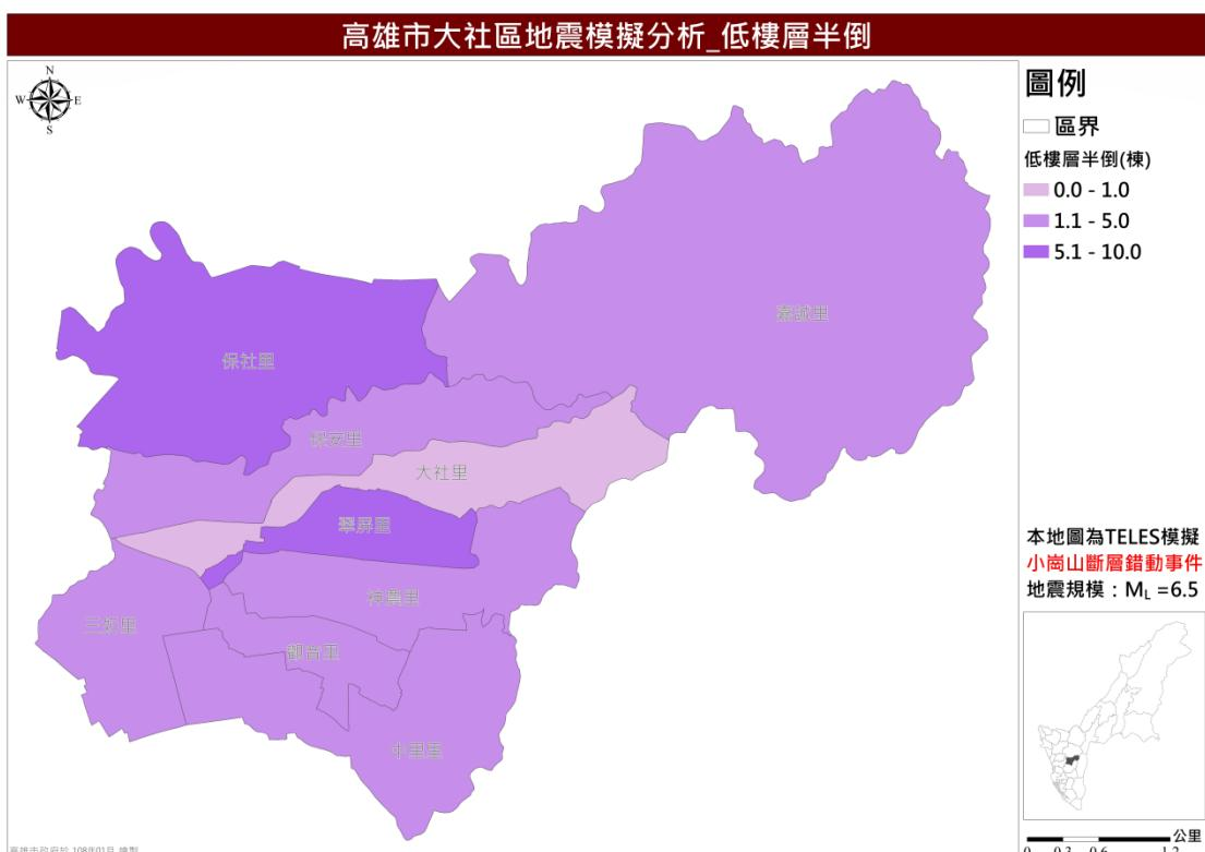
圖 20 小崙山斷層錯動事件低樓層半倒棟數推估圖
