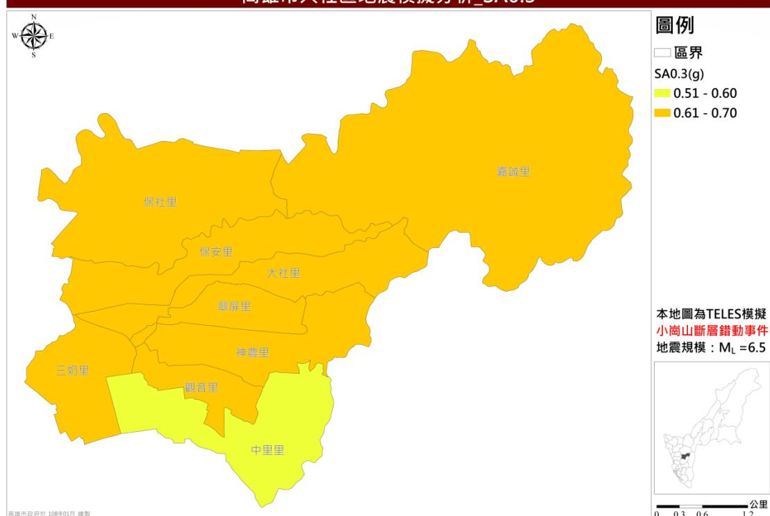
圖 14 小崙山斷層錯動事件短周期譜加速度 (SA0.3) 分布圖
