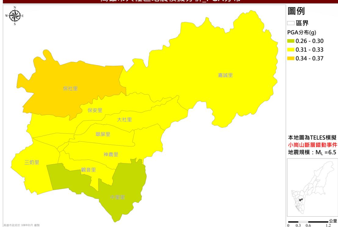
圖 13 小崙山斷層錯動事件最大地表加速度 (PGA) 分布圖
