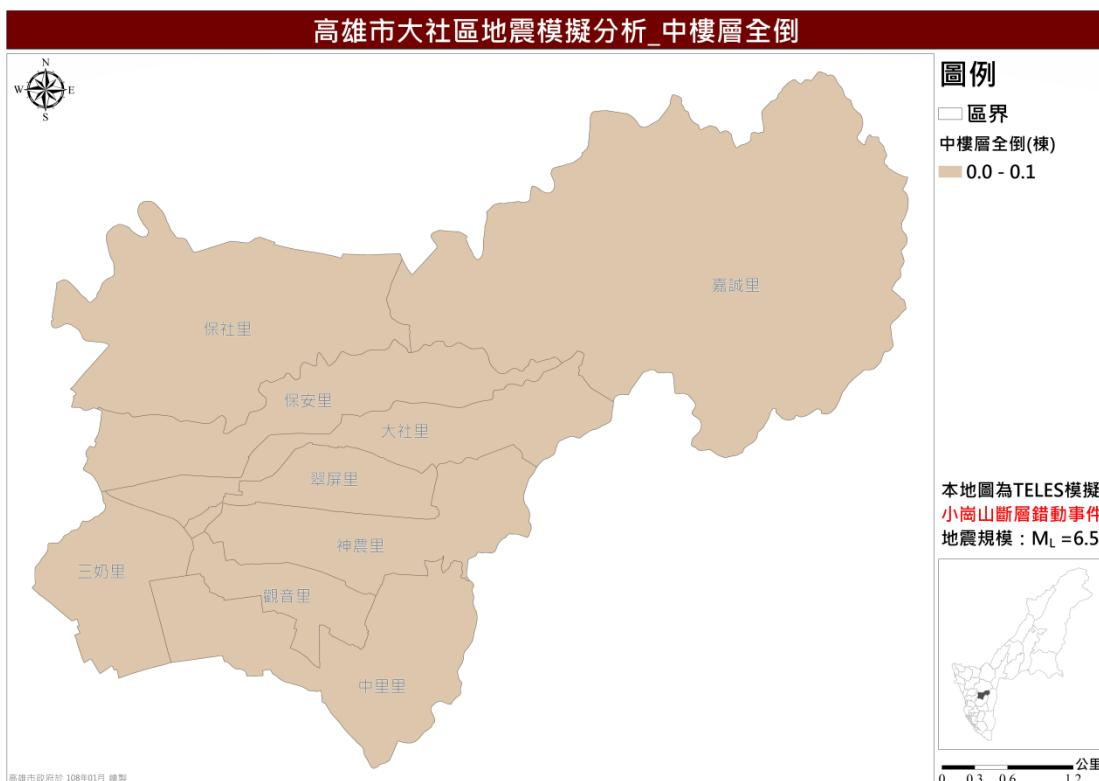
圖 18 小崙山斷層錯動事件中樓層全倒棟數推估圖
