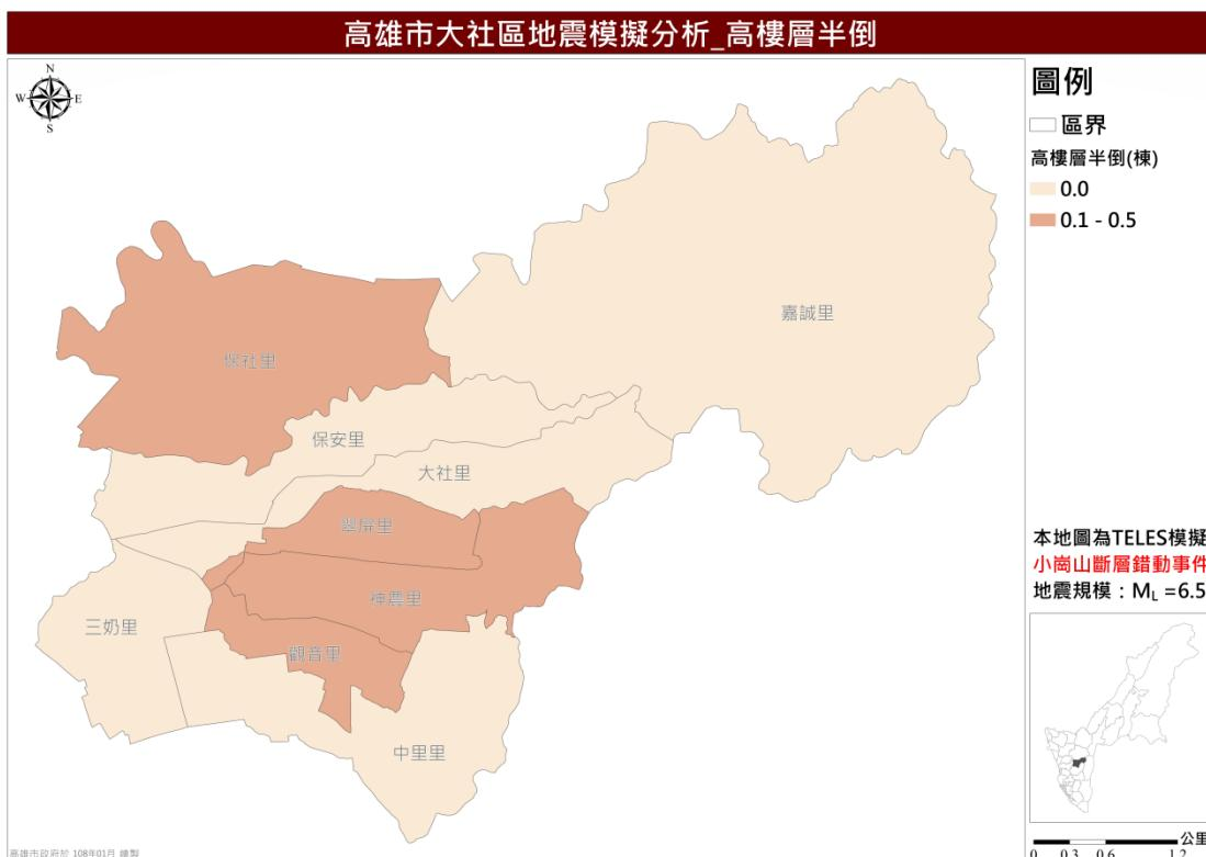
圖 22 小崙山斷層錯動事件高樓層半倒棟數推估圖
