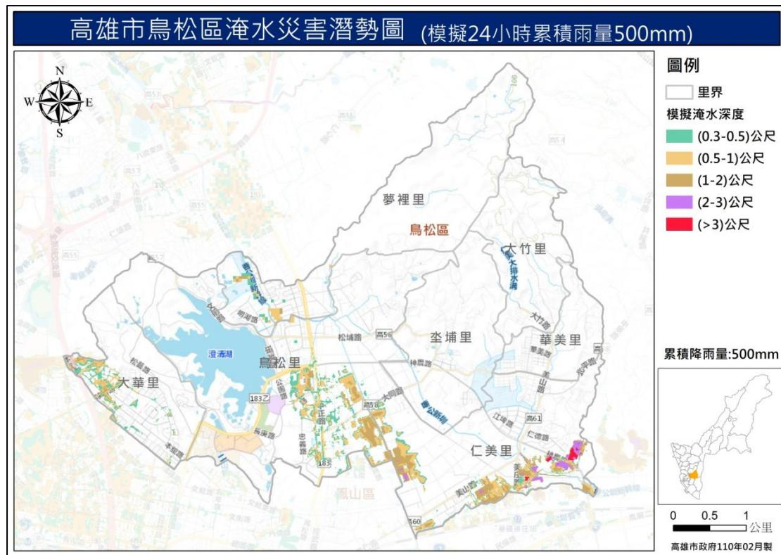
圖 6 鳥松區淹水災害潛勢圖 (模擬 24 小時累積降雨量 500mm)
