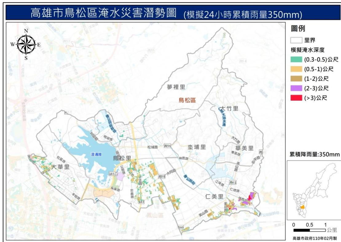
圖 7 鳥松區淹水災害潛勢圖 (模擬 24 小時累積降雨量 350mm)
