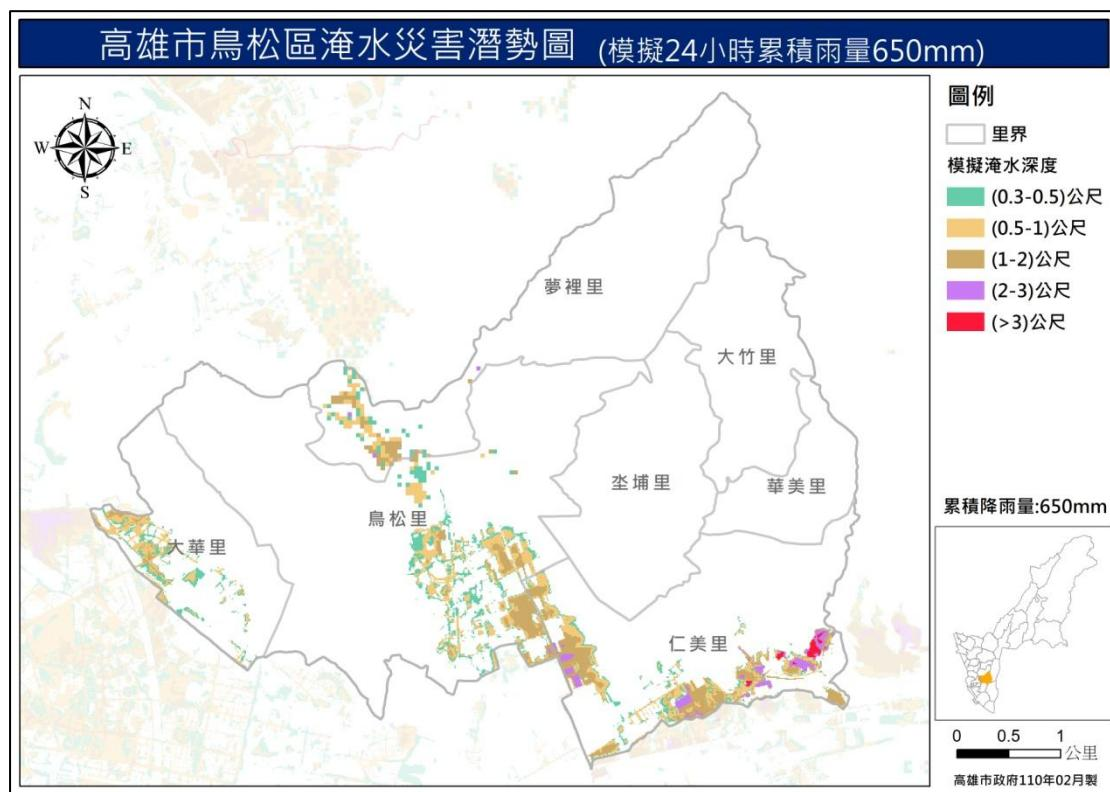
圖 5 鳥松區淹水災害潛勢圖 (模擬 24 小時累積降雨量 650mm)
