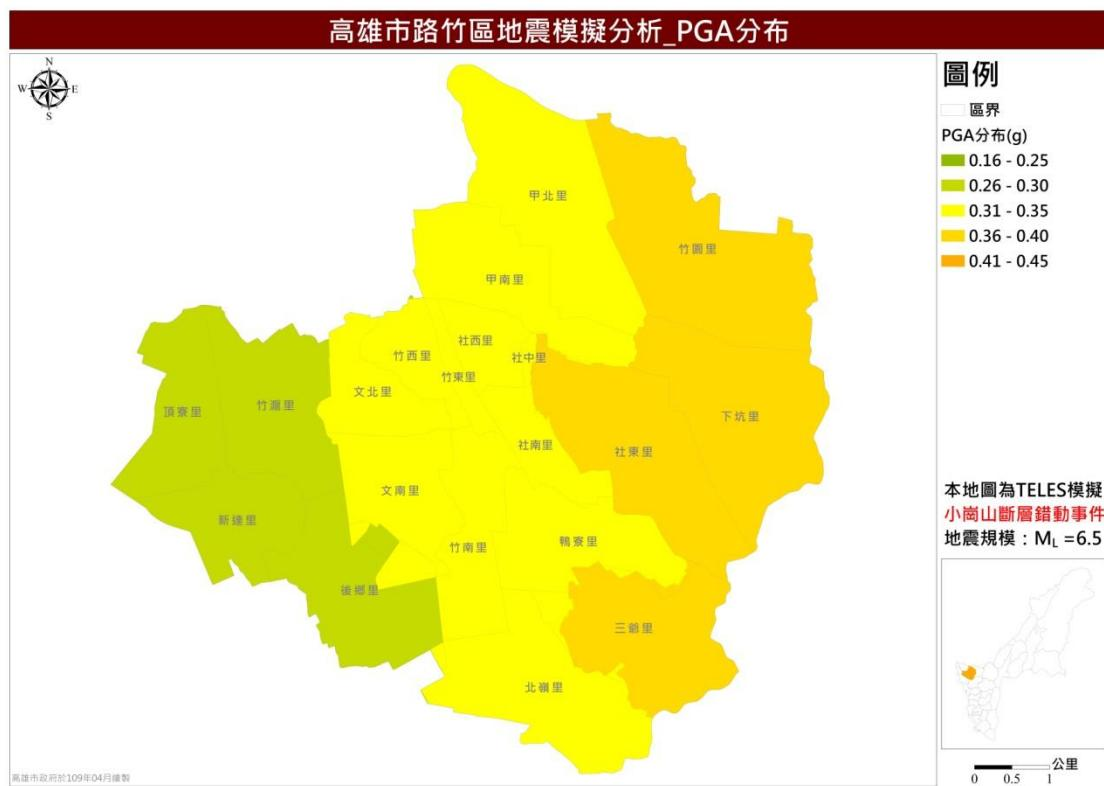
圖 5 小崙山斷層錯動事件最大地表加速度 (PGA) 分布圖
