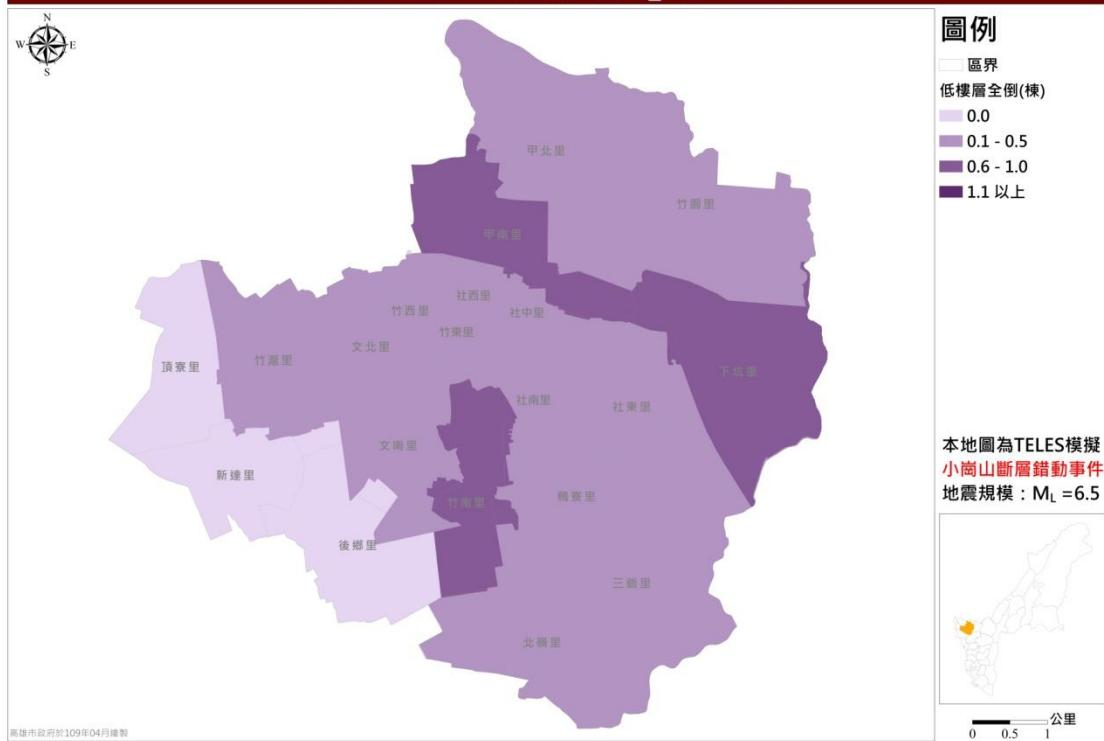
圖 9 小崙山斷層錯動事件低樓層全倒棟數推估圖
