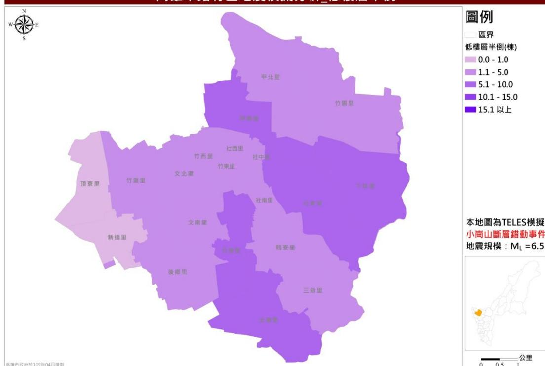
圖 18 小崙山斷層錯動事件低樓層半倒棟數推估圖
