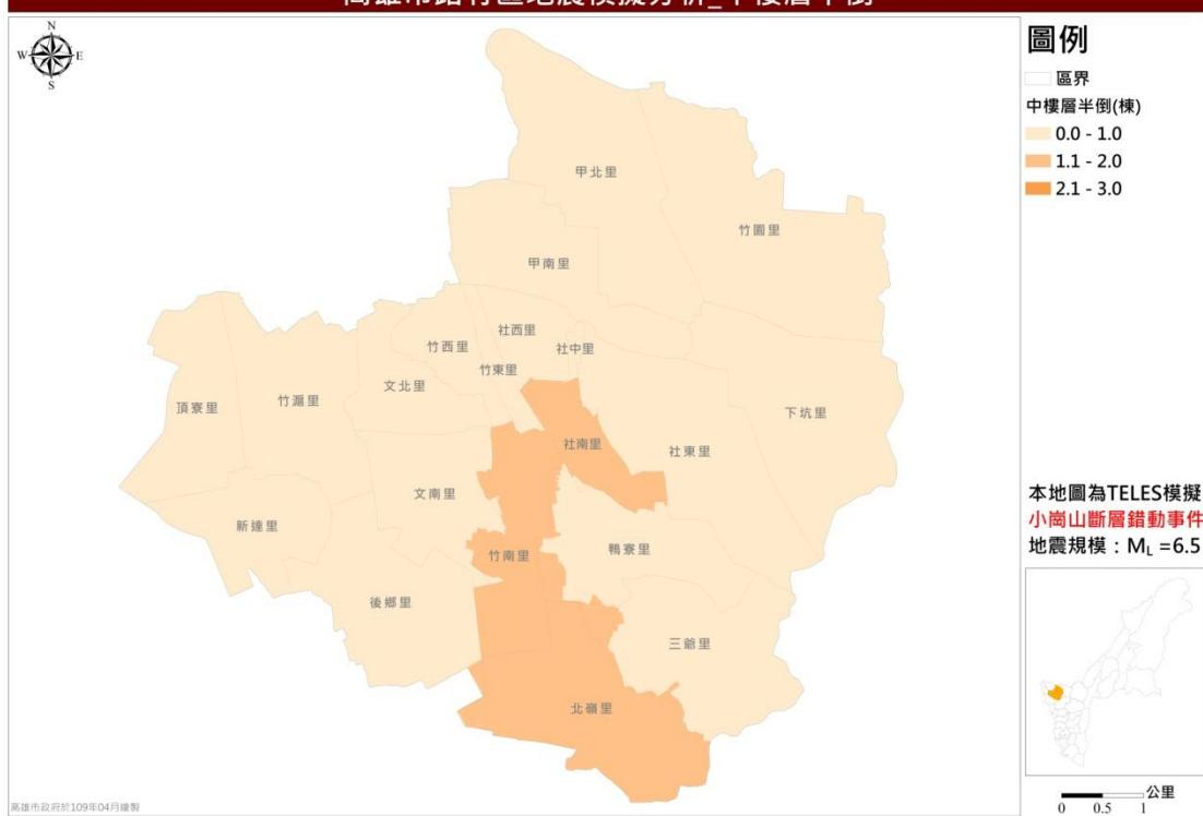
圖 19 小崙山斷層錯動事件中樓層半倒棟數推估圖
