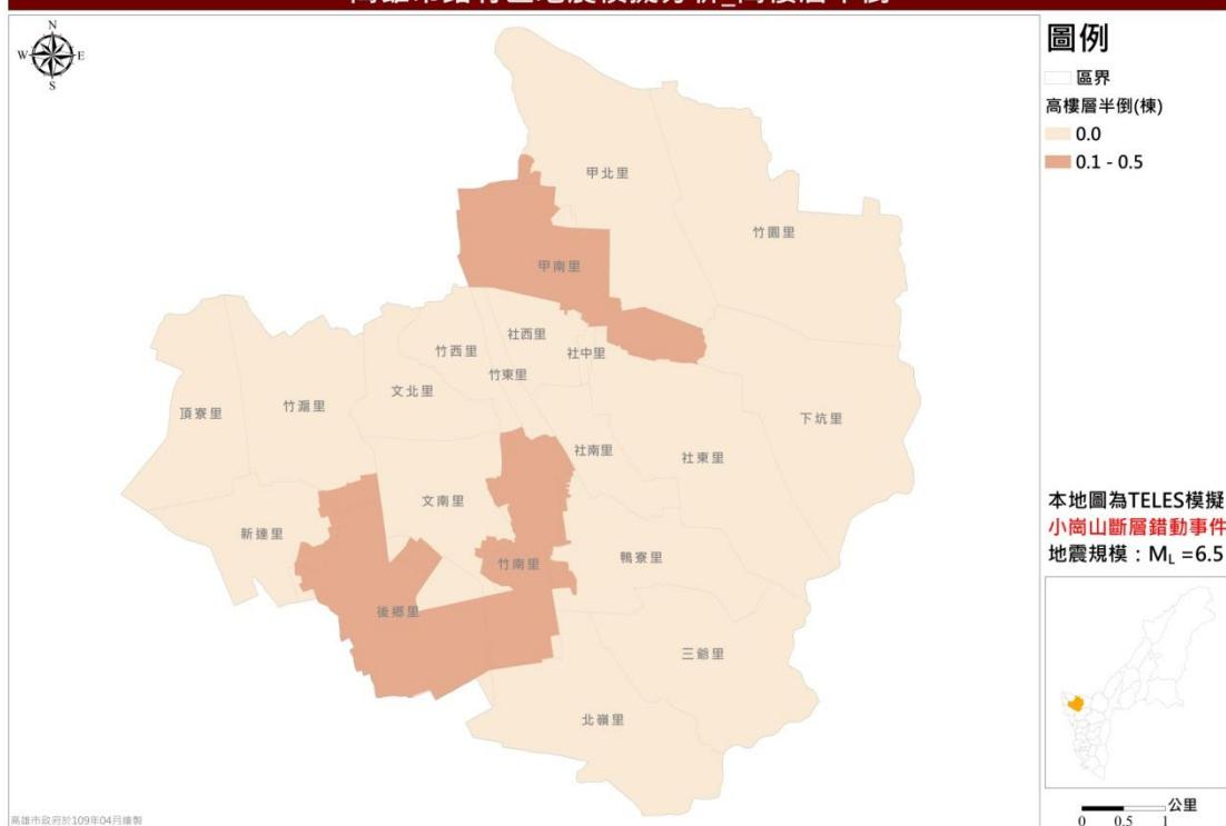
圖 10 小崙山斷層錯動事件高樓層半倒棟數推估圖
