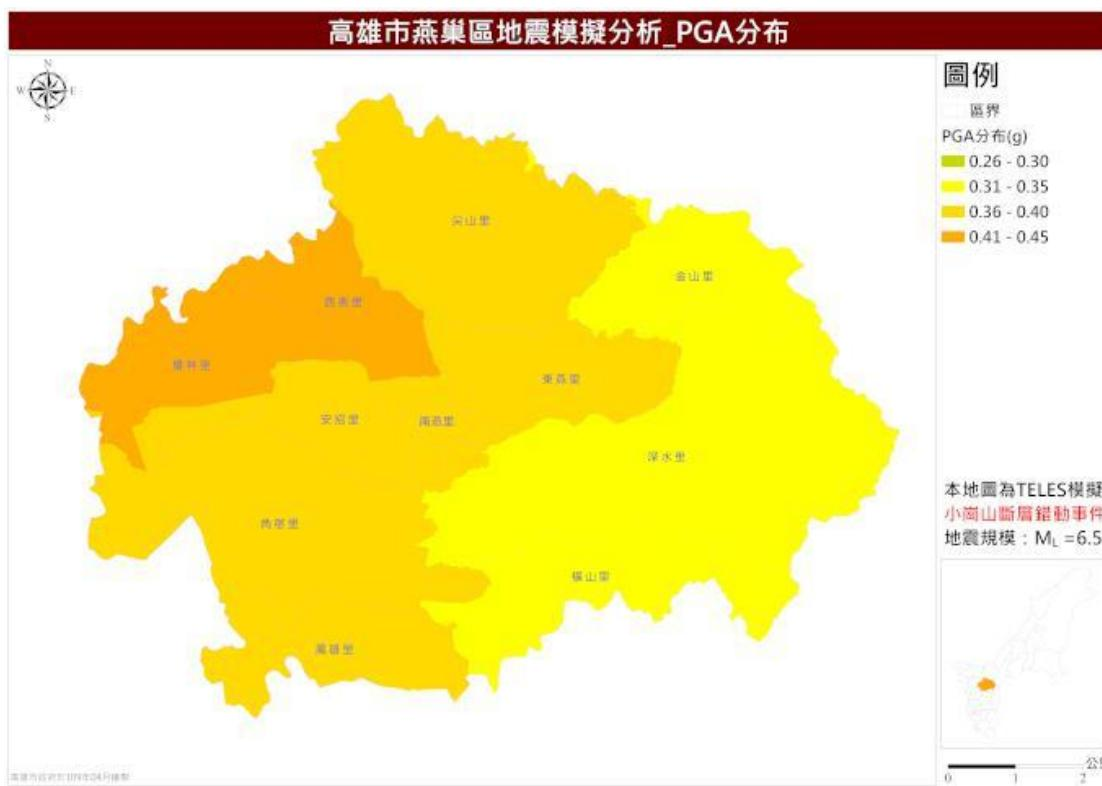
圖 15 小崙山斷層錯動事件最大地表加速度 (PGA) 分布圖
