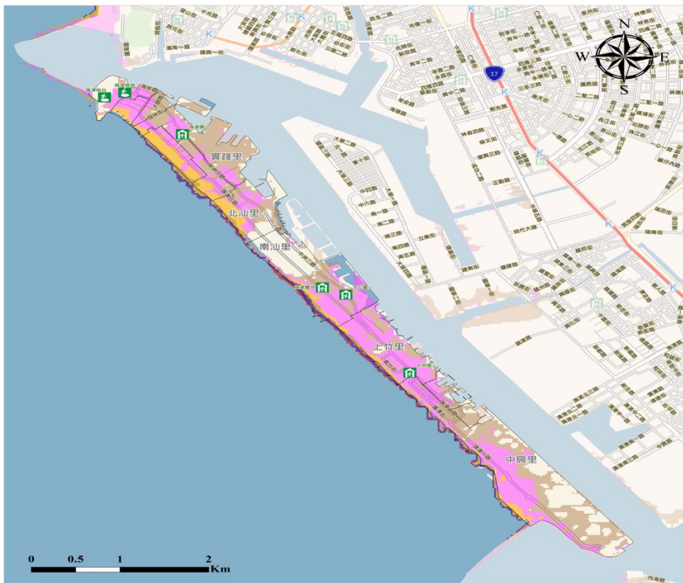
海嘯初始波高4.1公尺 編號 KHC-010-000(3/5) 高雄市旗津區海嘯災害溢淹潛勢圖
