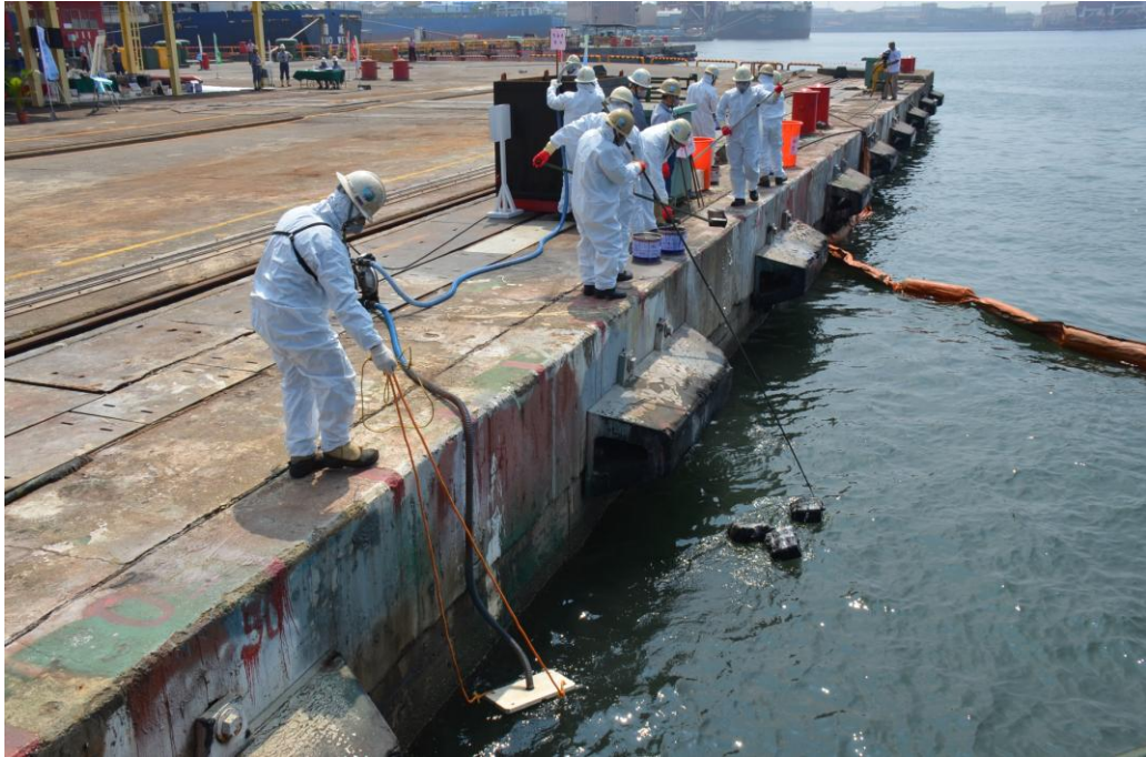
以汲油設備收集海上浮油
