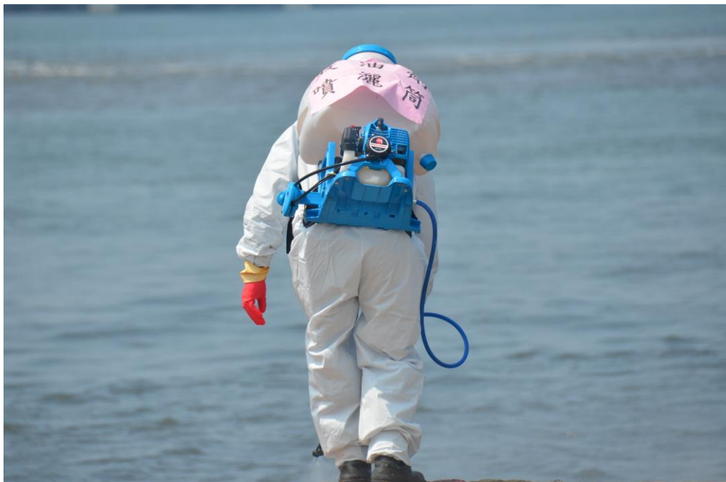
以油分散劑分解海上殘油
