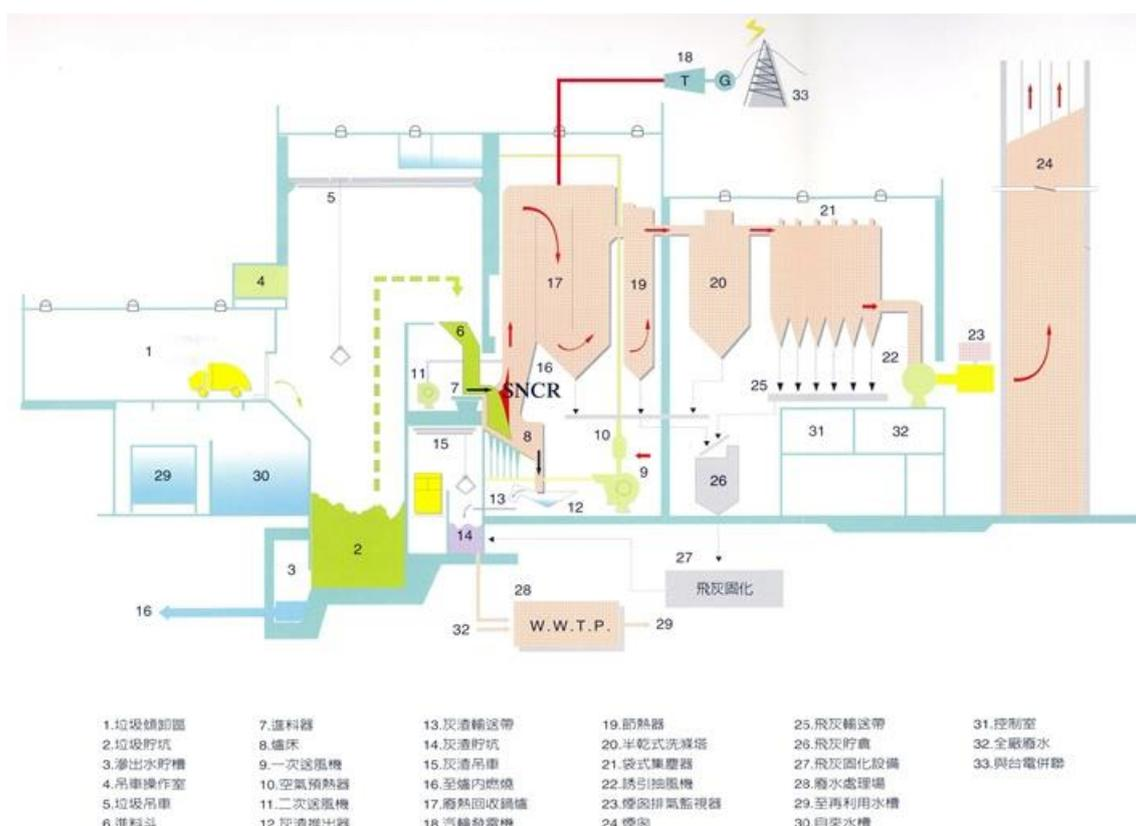
圖 5.1.4-1 仁武垃圾焚化廠全廠系統流程
