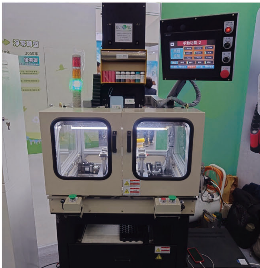
電池分離自動化推桿設備
