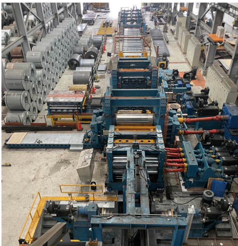
由開捲機、輥輪矯直機與剪板機組成的鋼捲整平機系統
