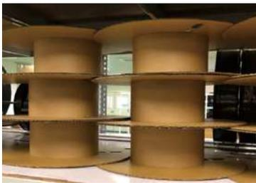
改採可多次使用之塑膠軸心，提高再使用率，減少資源浪費。上圖為修改前，下圖為修改後。
