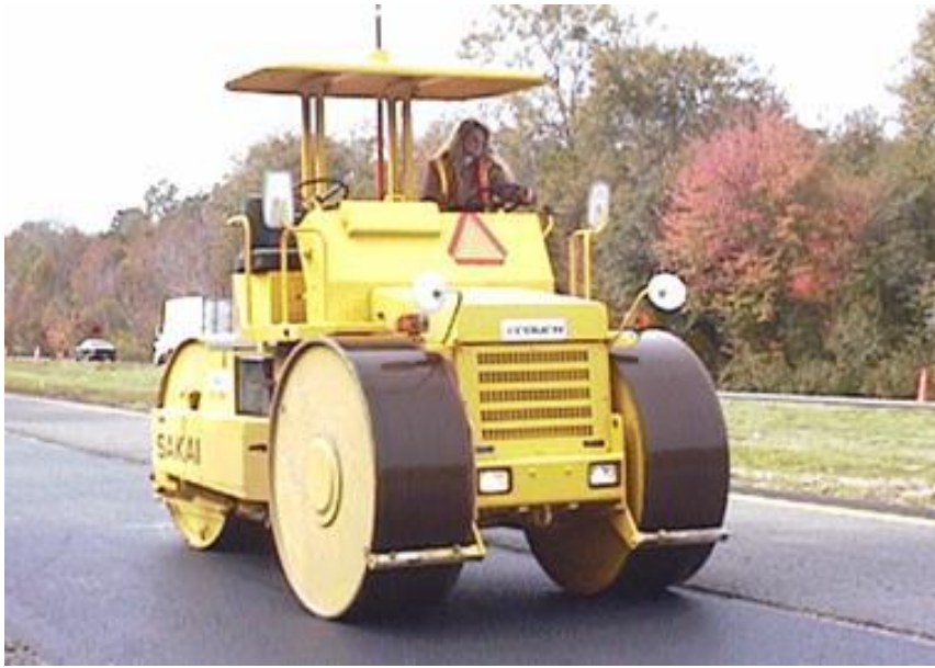
二軸三輪壓路機(初壓)壓實度 (約為 110^{\circ}\text{C}\sim 125^{\circ}\text{C} )
