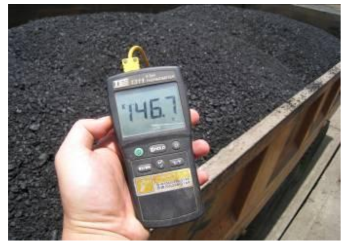
AC在拌合廠出發前量測瀝青混凝土溫度
