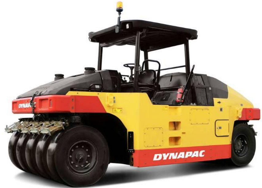
膠輪壓路機(複(次)壓) 消細裂縫、增水密性 、穩定性(約為 82^{\circ}\text{C}\sim 100^{\circ}\text{C} )
