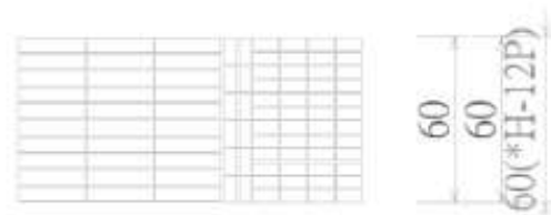
不同尺寸磁磚接法
