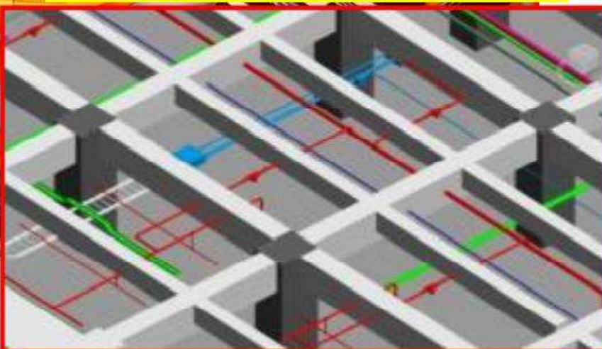
機水電管路配置及衝突檢討
