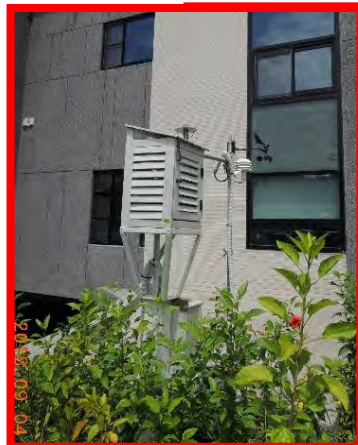
小型氣候站 溫度、濕度、CO 2 、環境資訊
