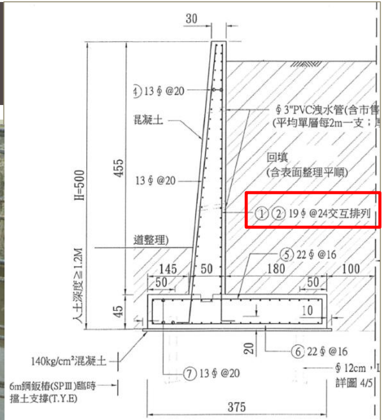
護岸擋土牆修復斷面配筋圖(H=5.0m)
