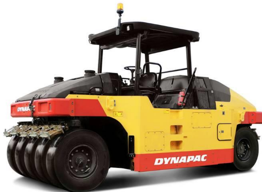
膠輪壓路機(複(次) 壓)消細裂縫、增水 密性、穩定性
