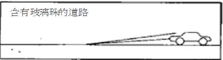
圖 3.2 標線中玻璃珠的反光原理
