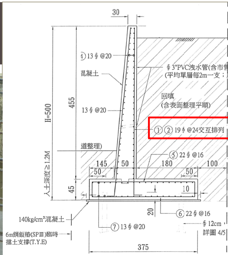
護岸擋土牆修復斷面配筋圖(H=5.0m)
