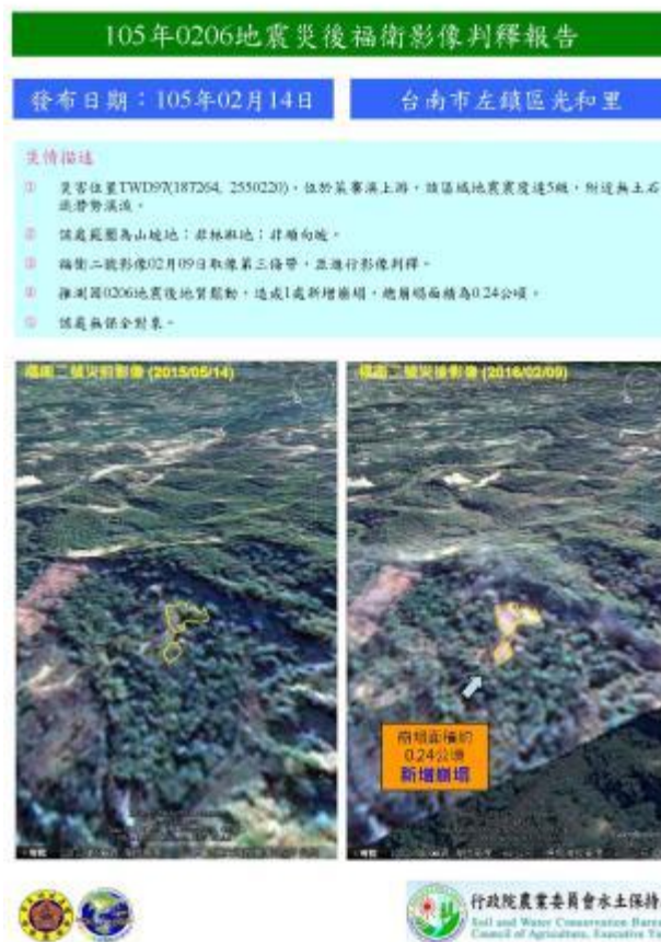
圖 4.1.2、福衛二號影像判釋臺南市左鎮區光和美新增崩塌
