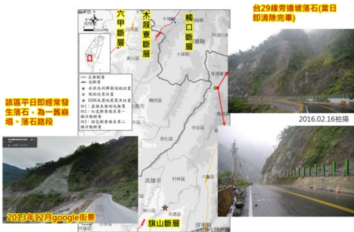
圖 4.2.10、高雄市那瑪夏區台 29 線落石情形（資料來源：災防科技中心）
