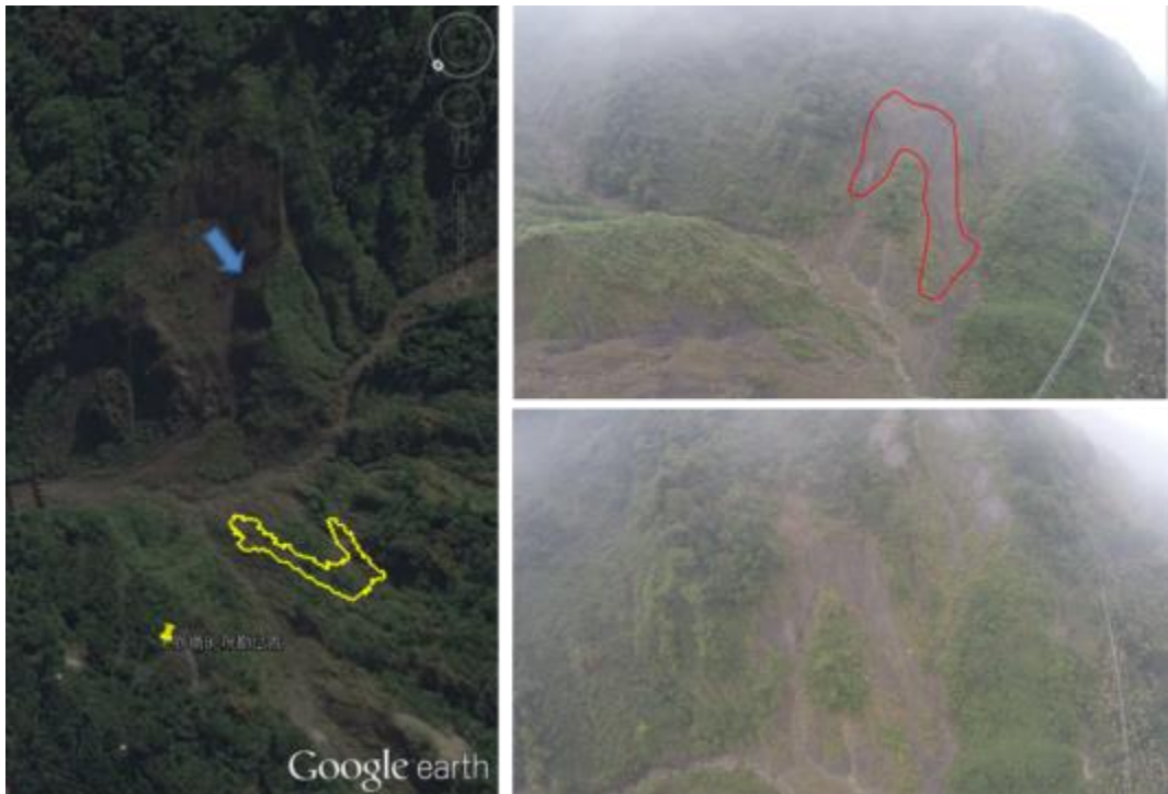
圖 4.2.13、中崙村內新增之崩塌 B(0.23 公頃) ，左下標記點為現勘位置與右下為 UAV 空拍照片(雲科大提供)，黃線區域為水保局衛星影像判釋之結果。上圖左右分別為前期(2014)與後期(2016/2/8)之衛星影像。
