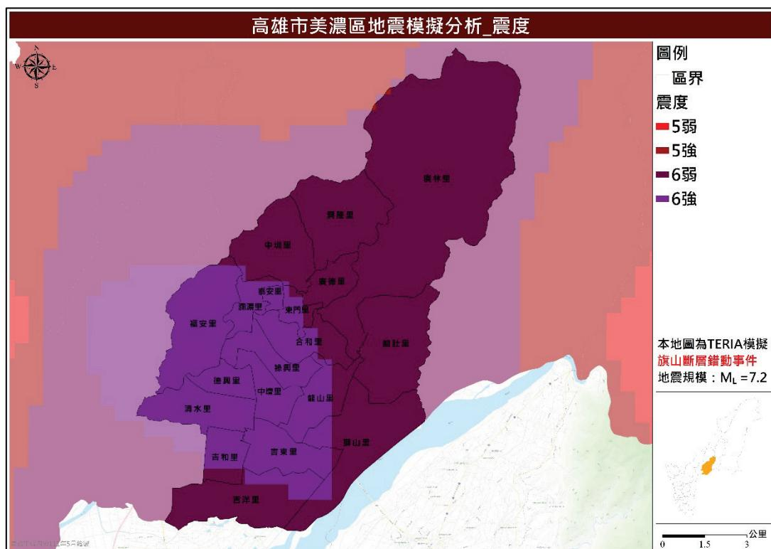
圖 14 旗山斷層錯動事件震度分布圖
