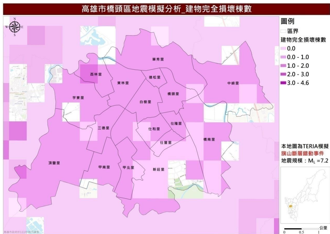
圖 19 旗山斷層錯動事件建物完全損壞棟數推估圖
