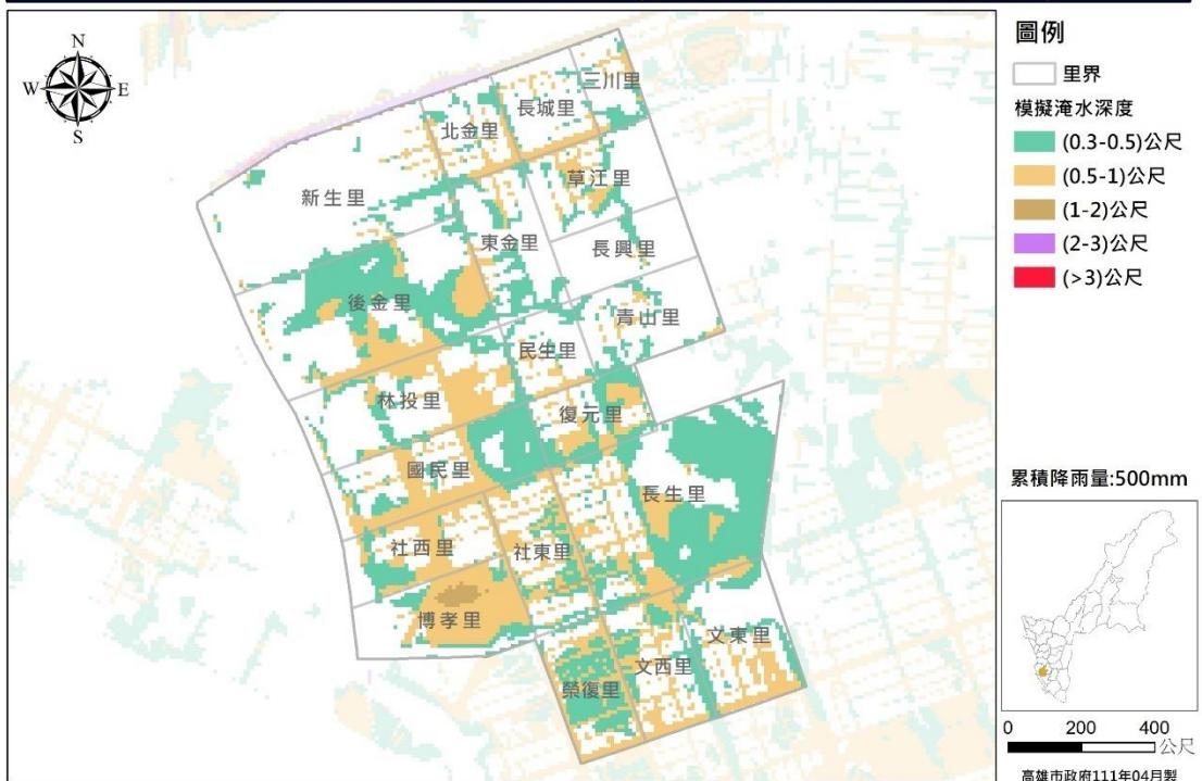
圖 7 前金區淹水災害潛勢圖 (模擬 24 小時累積降雨量 500mm)
