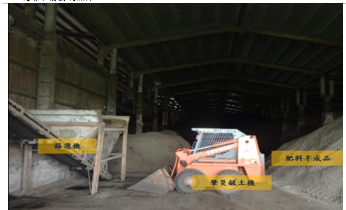
說明一 災害當時罹災勞工操作鏟土機進行肥料半成品分篩作業。
