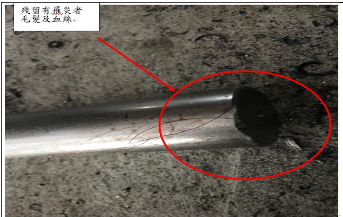
說明二 搓牙機軸心鐵條尾端殘留有柯罹災者毛髮及血絲。
