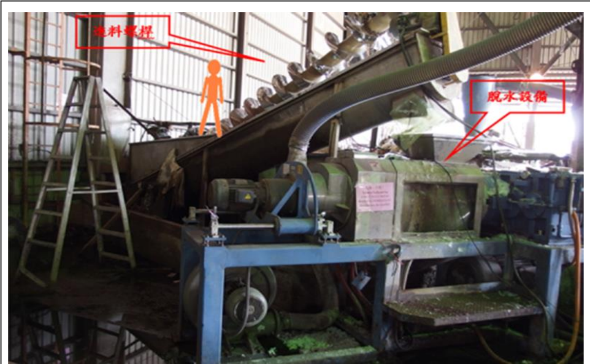
說明一 越南籍勞工杜罹災者攀爬至送料螺桿外殼上方。
