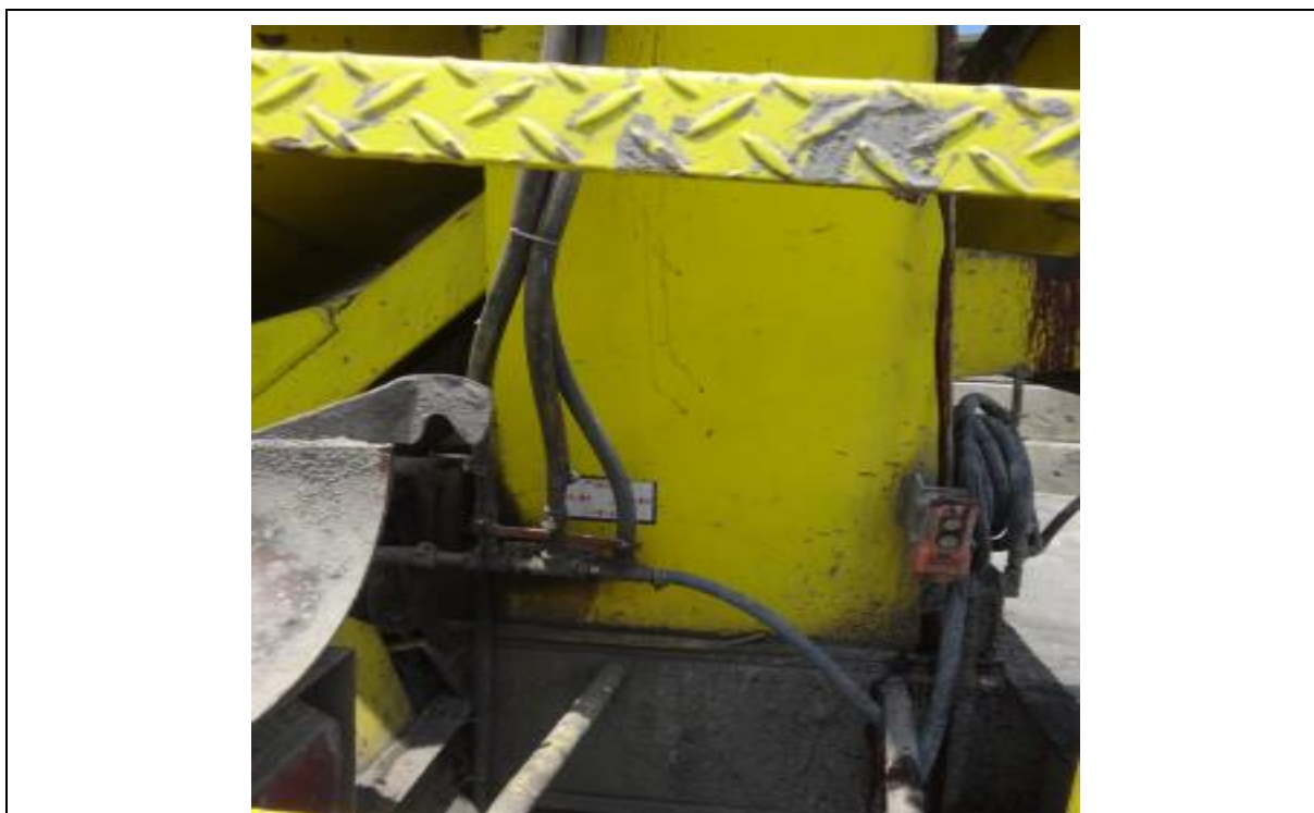
說明四 預拌混凝土車水管之配置。(分別通往錐形漏斗、三角漏斗、橫放於桶槽口及三角漏斗間、車後)
