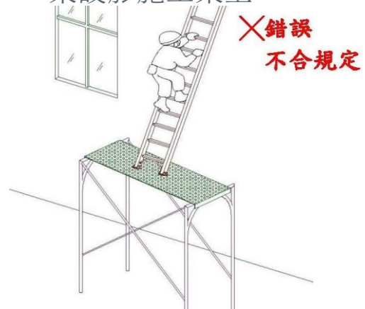
架設於施工架上
