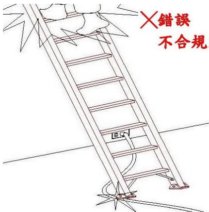
絕緣破壞致感電
