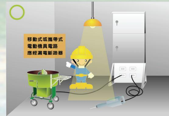
四、勞工於作業中或通行時,有接觸絕緣被覆配線或移動電線或電氣機具、設備之虞者,應有防止絕緣被破壞或老化等致引起感電危害之設施。
