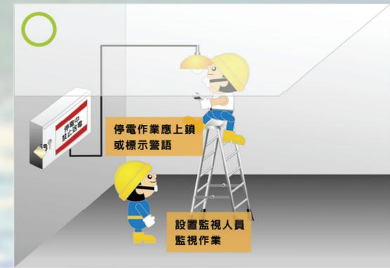
六、為調整電動機械而停電,其開關切斷後,須立即上鎖或掛牌標示並簽字之。復電時,應由原掛簽人取下安全掛簽後,始可復電,以確保安全。
