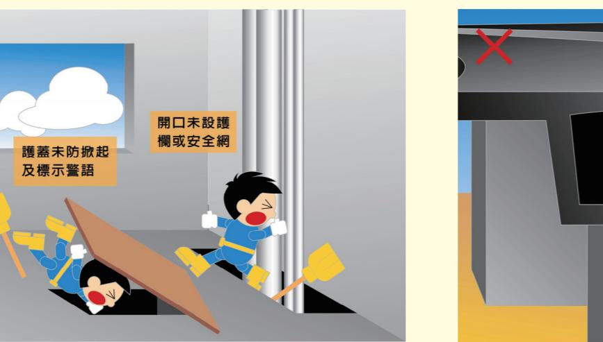
二、橋樑工程之箱型樑應保持充分之光線，臨時性開口處使用之護蓋，表面漆以黃色並書以警告訊息，已廢止使用之開口應予封閉。
