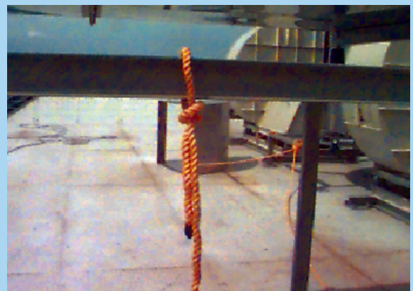
步驟四 完成越拉越緊的結。多餘的線頭可再打一個副結。
