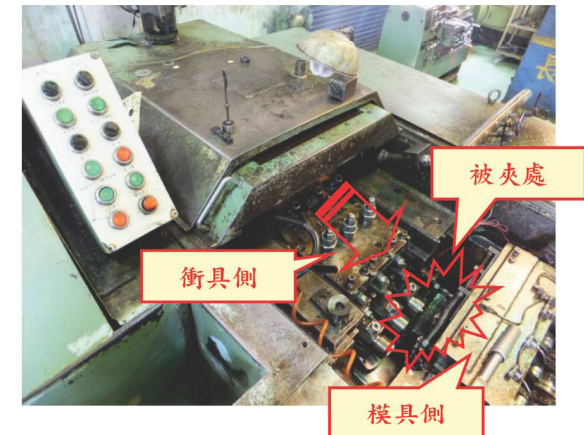
圖3：勞工丁遭成型機夾傷示意圖。
