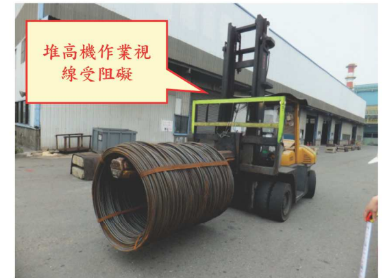
圖2：勞工乙駕駛堆高機運送盤元模擬圖，堆高機右轉時，視線遭拖車擋住。
