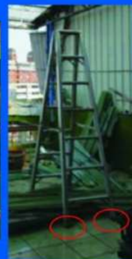
合梯腳部座意損壞且立於光滑磁磚地，造成作業中合梯滑動，人員墜落致死。
