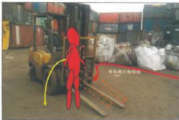
圖 2：勞工甲遭堆高機撞擊示意圖。
