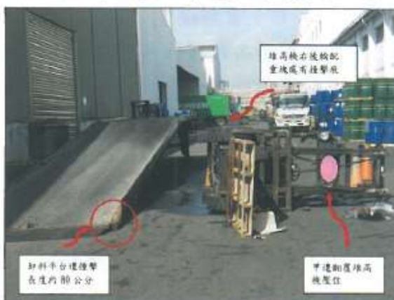
圖 3：勞工甲駕駛堆高機，因後退撞擊卸料平台斜坡後重心不穩翻覆。
