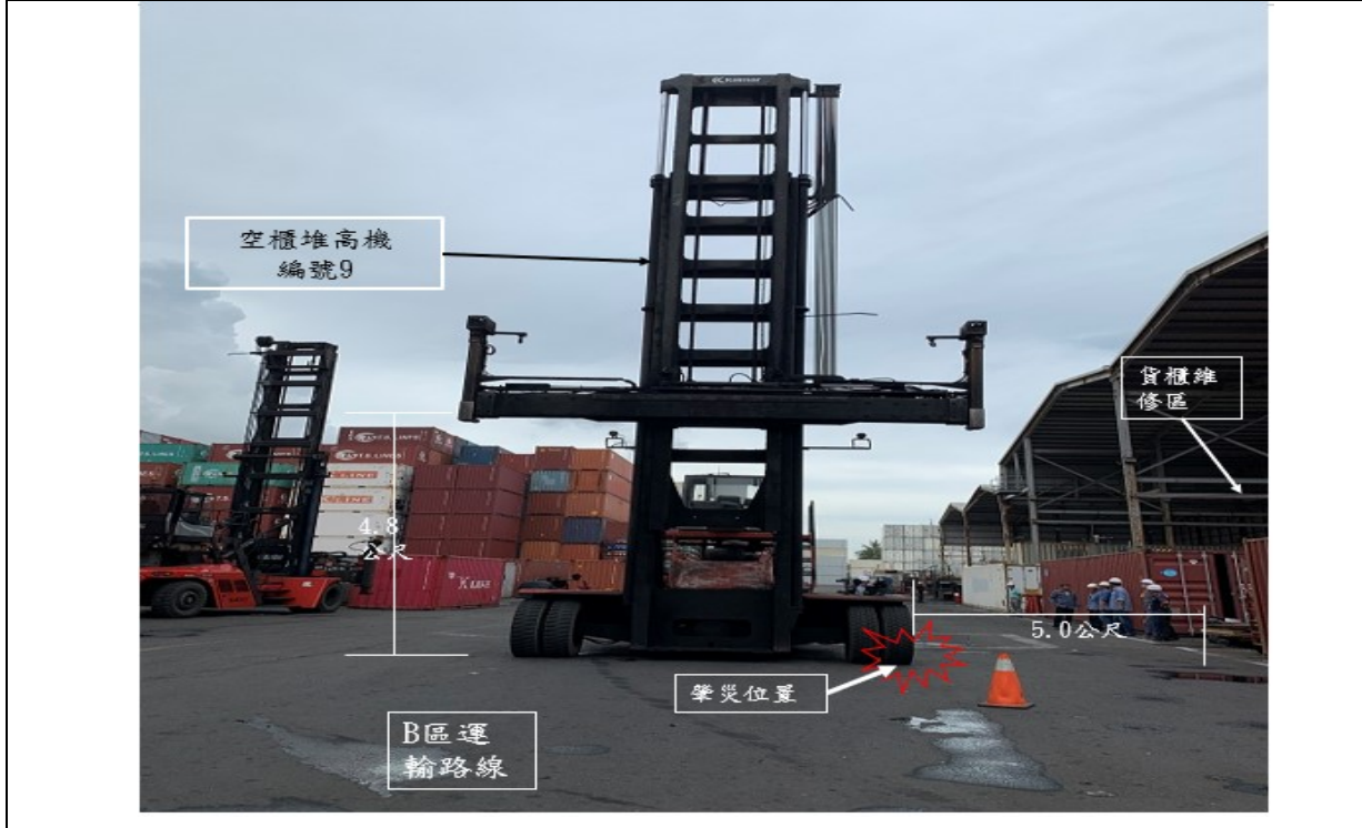
說明 2 災害現場之堆高機及罹災勞工相關位置圖。
