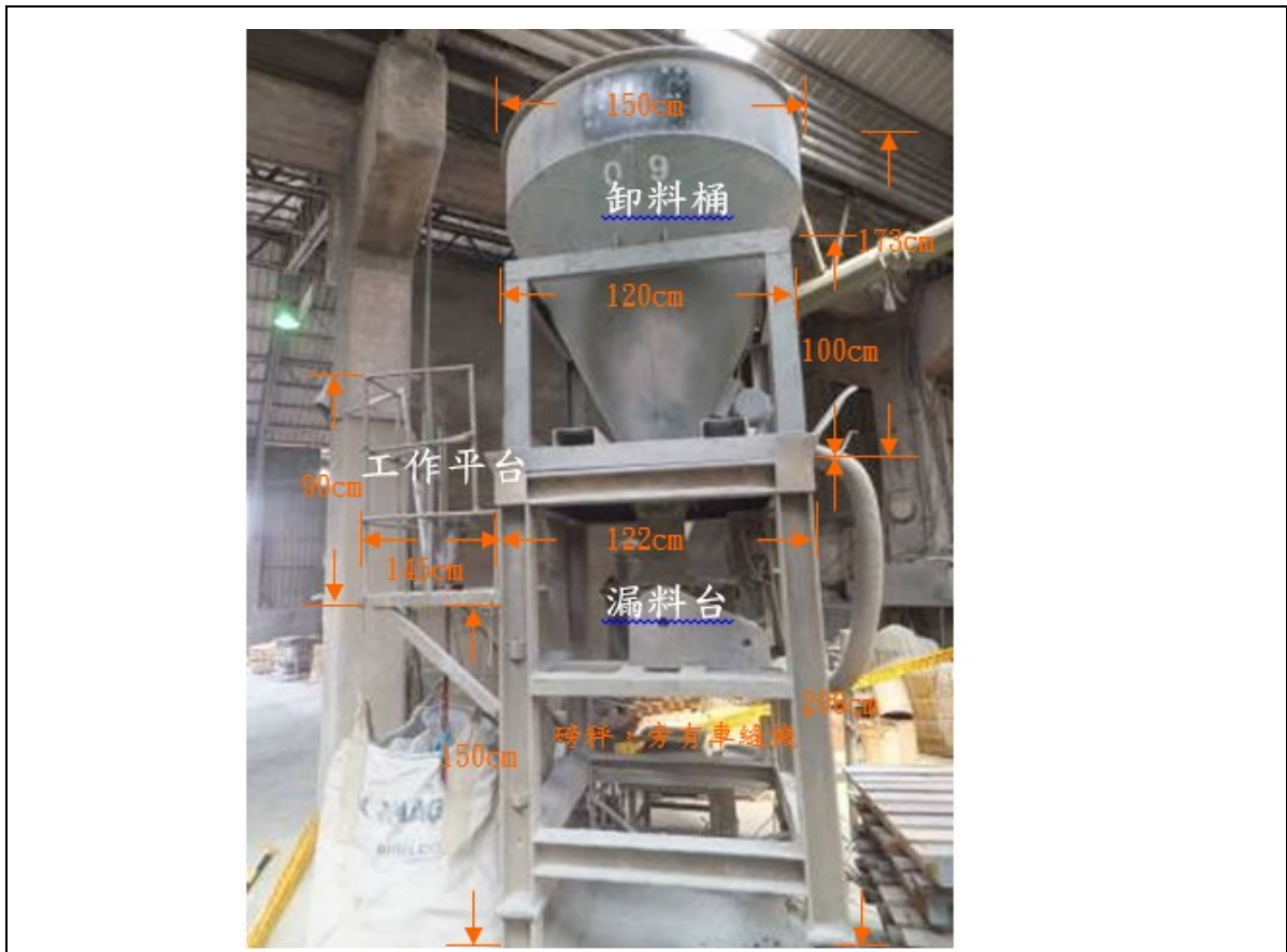
說明一 卸料桶、工作平台、漏斗台尺寸示意圖。
