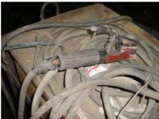
罹災者握持之焊接炳電線絕緣被覆已破損。
