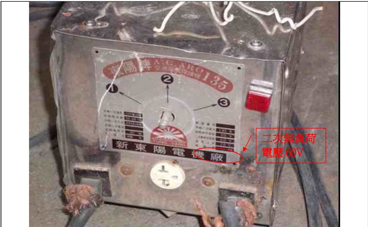
照片 2、罹災者作業時所使用之電焊機。(未有自動電擊防止裝置)
