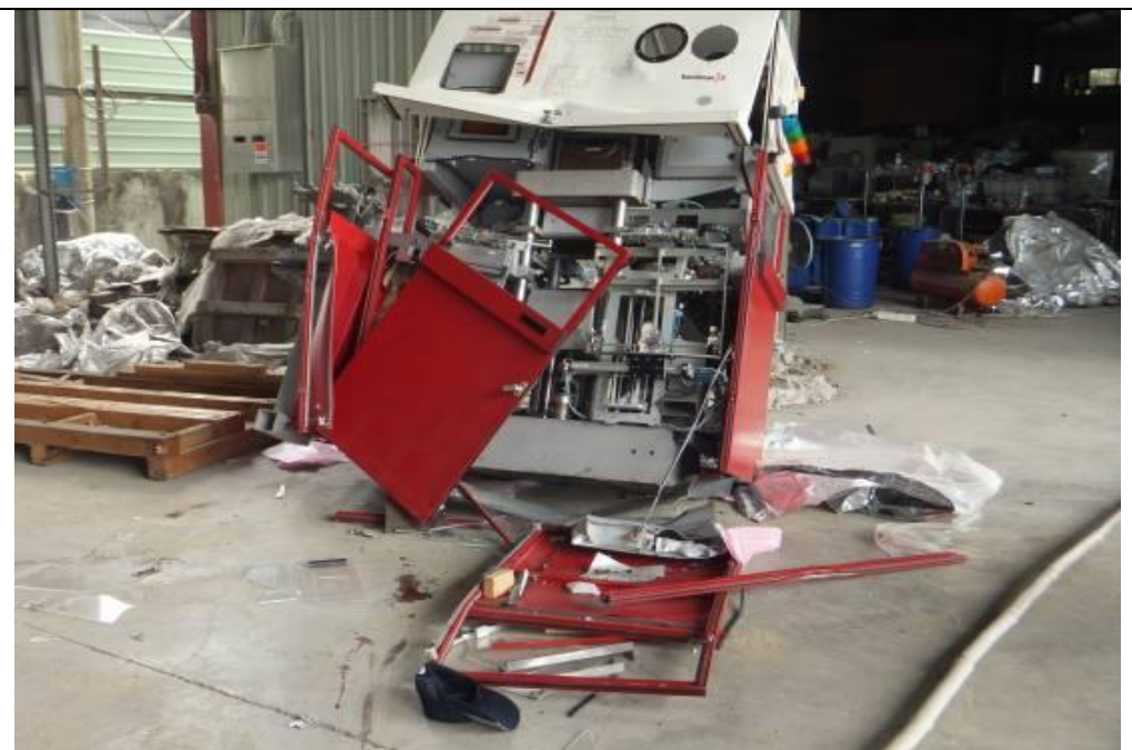
傾倒翻落後之壓模機(重約 2,250 公斤)及棧板。
