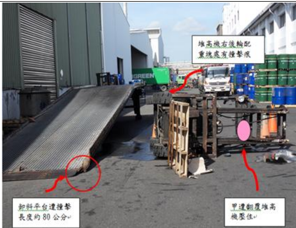
卸料平台遭撞擊新痕，長約 80 公分，堆高機檔位停留在後退檔。
