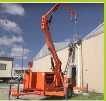
移動式錨錠繫固裝置與捲揚式防墜器(例)
