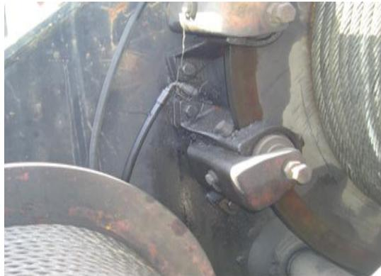
圖 10 油壓系統漏油
