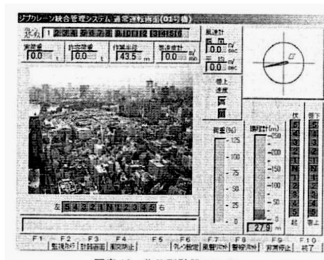
圖 23 塔式起重機的「起重機操作情報支援系統」畫面
