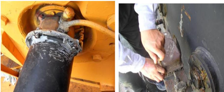
圖 6 過捲預防裝置外殼破裂未具防水功能
