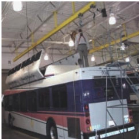
圖2 懸吊式滑軌防墜裝置使用狀況（一）
