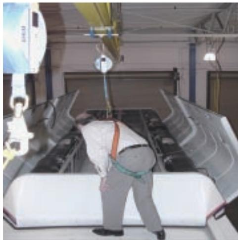
圖3 懸吊式滑軌防墜裝置使用狀況（二）
