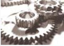
◎機械作動:機械之運動包括旋轉、往復、直線等，此類型之危害主要發生於操作點或動力傳送之聯結處。任何機械之旋轉部份都有危險性，即使圓滑的表面、旋轉緩慢的轉軸也都有可能捲住衣服或頭髮而造成嚴重災害。飛輪、離合器、聯軸器、螺桿、橫軸或直立軸均屬旋轉動作常見例子，當這些附屬設備有螺帽或突出鍵時會更危險。往復及直線運動之機件危險存在於其動作範圍內，勞工可能被擠拉或擠壓於固定物及運動物間，另物體之破裂、飛散、反彈等亦會造成勞工嚴重之災害。
