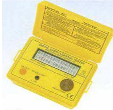
洩漏電流檢測計
