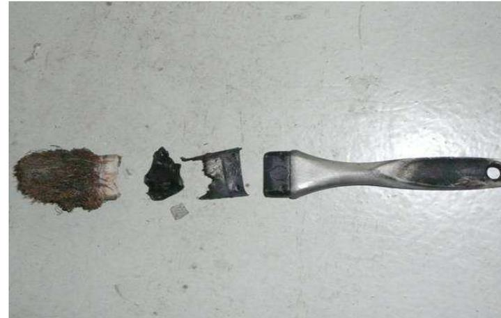
研判使用之毛刷上附有雜質，或所包覆鐵器部分之膠帶破損，致產生電弧
