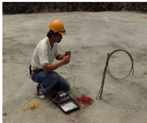
D. 接地電阻量測結果
