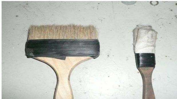
檢查及清理控制盤使用之毛刷；鐵器部分以膠帶包覆
