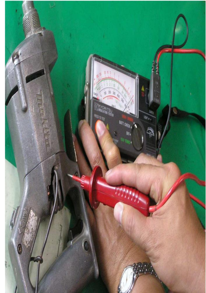
作業人員以鐵絲勾掛電鑽，電鑽外殼破損。
