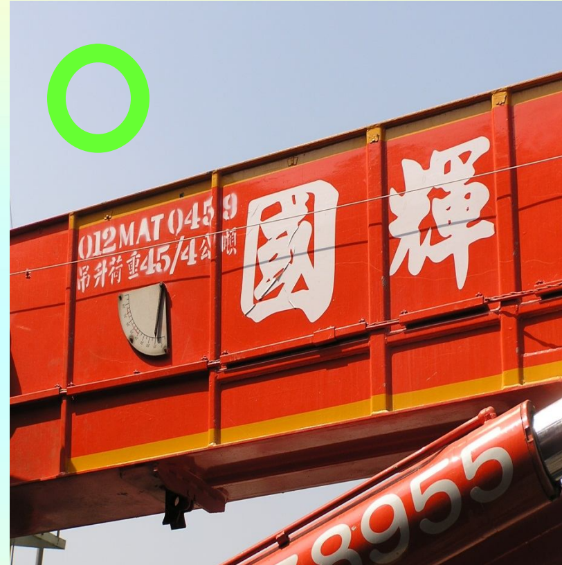
起重機依規定標示最高荷重
