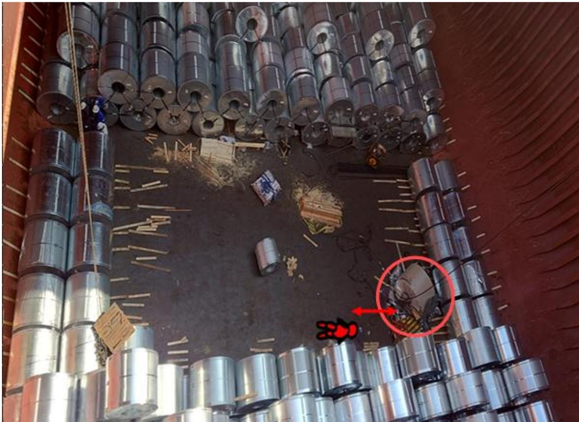
▲ 船艙內，罹災者遭落下鋼索撞擊致死，距掉落鋼卷位置約 2 公尺。
