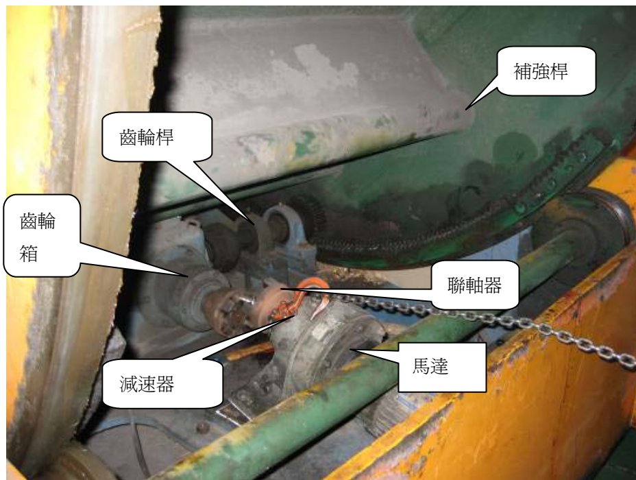
照片 2 罹災者使用榔頭敲打聯軸器，使聯軸器與包裝平台脫離、手動鏈滑輪固定於馬達
