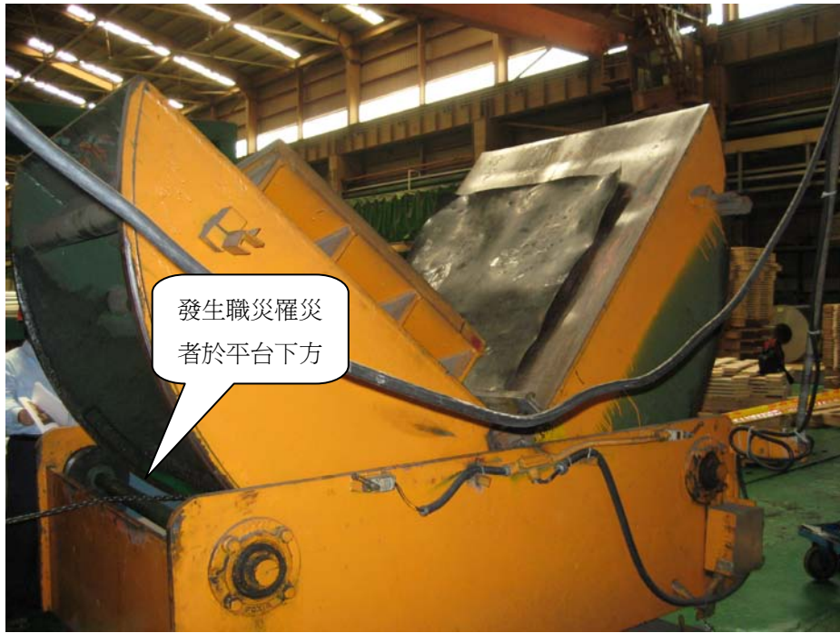
照片 1 原事業單位軋鋁一廠冷軋課東側鋁捲包裝翻轉機外觀
