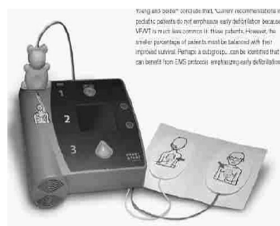
圖示：成人和兒童的自動體外去顫器配備，二者使用機器相同，不同在於貼片與
