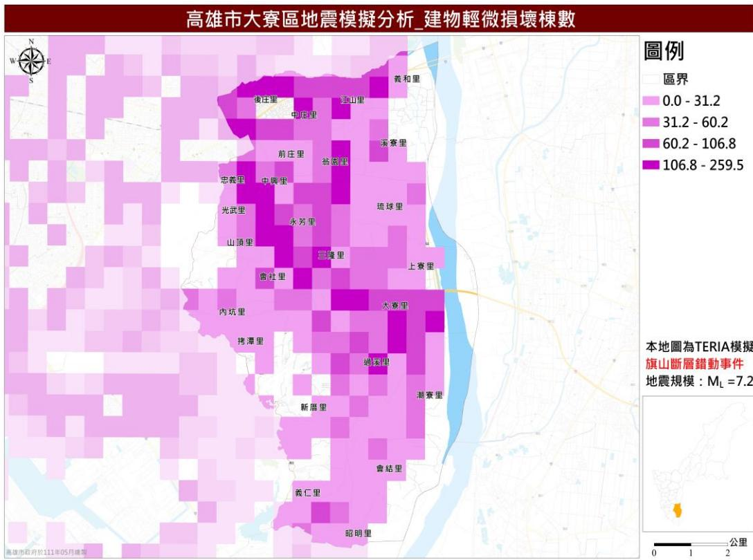
圖 18 旗山斷層錯動事件建物輕微損壞棟數推估圖
