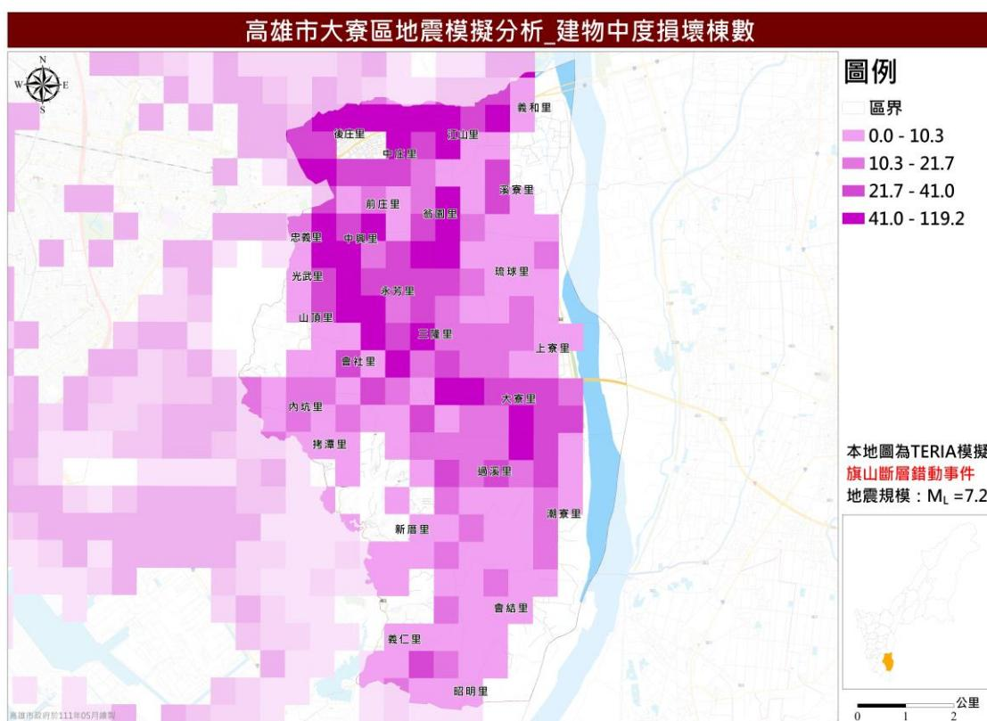
圖 17 旗山斷層錯動事件建物中度損壞棟數推估圖
