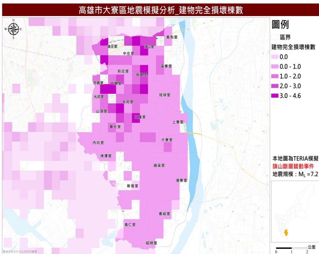
圖 15 旗山斷層錯動事件建物完全損壞棟數推估圖
