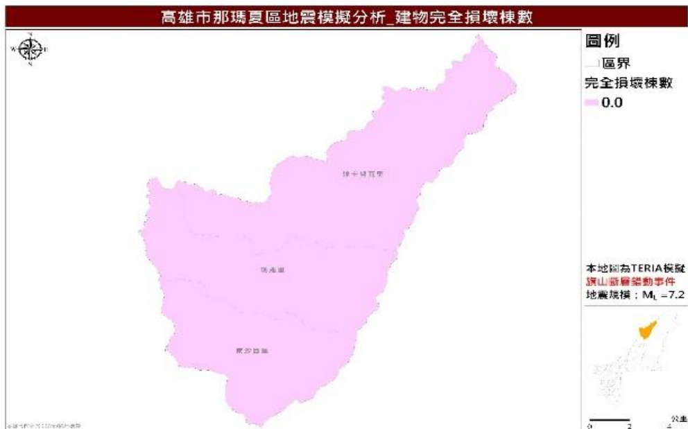
圖 10 旗山斷層錯動事件建物完全損壞棟數推估圖
